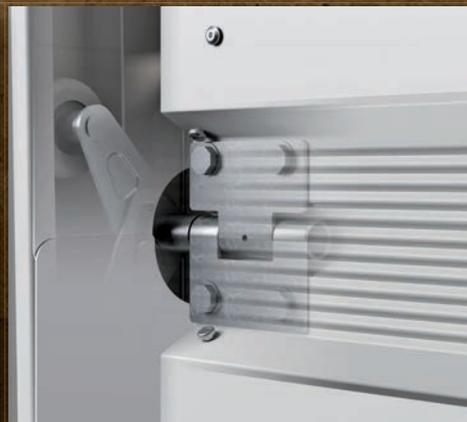
6. Подвижные защитные крышки роликов и направляющих
